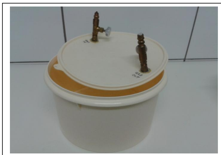
Figura 9 – Recipiente hermeticamente fechado, do tipo Tupperware®, adaptado com sistema de válvulas para a introdução da mistura de gás necessária à cultura in vitro do Plasmodium falciparum .
